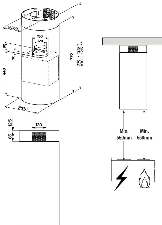
\* Габариты всасывающей вытяжки.
