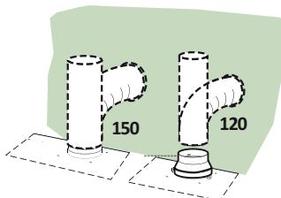
Imemisfunktsiooniga versiooni paigaldamiseks ühendage õhupuhasti väljutustorudega jäига või paindtoru abil, mille läbimõõt on Ø150 või 120 mm, mille valiku jätab paigaldaja.
