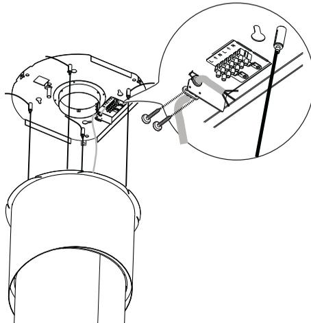
Zuletzt kontrollieren, ob das Stromkabel korrekt blockiert ist, beim Anheben des beweglichen Körpers zur Decke hin über diesem bleibt und nicht über die Konturen der Haube hinausragt.
