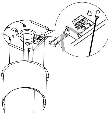
Verificar por último que el cable de alimentación quede bloqueado correctamente, controlando que cuando el cuerpo móvil se levanta hacia el techo, éste se posicione arriba del cuerpo móvil y no sobresalga del contorno de la campana.
