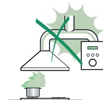
Conecte la campana extractora al conducto de humo a través de un tubo con un diámetro mínimo de 120 mm. La trayectoria del humo debe ser lo más corta posible.
