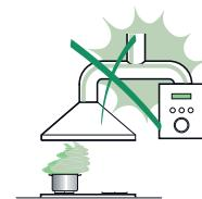
Slut emhætten til røgafrækket ved hjælp af et rør med en diameter på min. 120 mm. Rørforbindelsens gennemgang skal være så kort som mulig.
