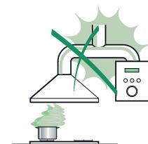
Aspiratörü egzoz bacasına minimum çapı 120 mm olan bir boru vasıtıyla bağlayın. Baca hattı mümkün olduğu kadar kısa olmalıdır.
