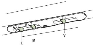
**L** Освещение Включает и выключает осветительное оборудование
