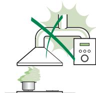
Conectați ventilatorul extractor la conducta de evacuare a fumului cu ajutorul unei conducte cu diametrul minim de 120 mm. Traseul fumului trebuie să fie cât mai scurt posibil.
