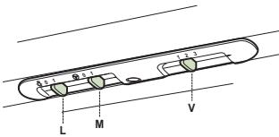
**L** Освещение Включает и выключает осветительное оборудование
